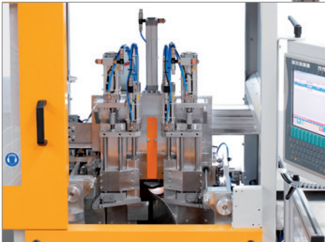
Modular aufgebaute Spann- und Sägeaggregate
